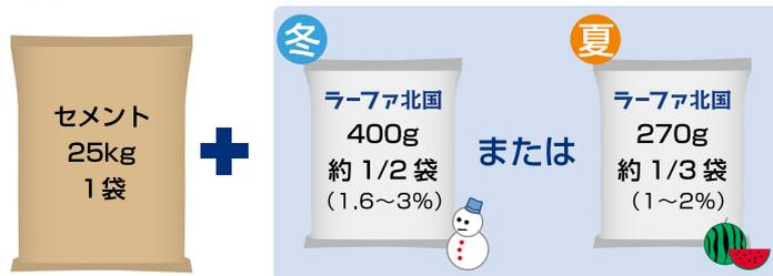
モルタルに規定量のラーファ北国を加え、空合わせ(30秒)をしてから、規定量の水を加え、3分間混練してください。
