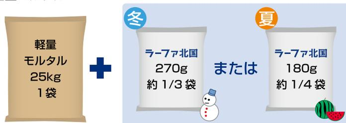
軽量モルタルに規定量のラーファ北国を加え、空合わせ(30秒)をしてから、規定量の水を加え、3分間混練してください。
